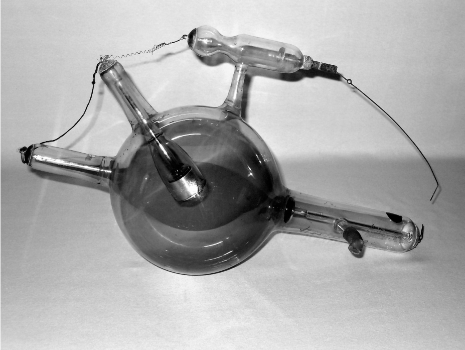
5. ábra. Univerzális Müller-röntgenső toldaléksövel, sorozatszama 44838. Neheztített antikatóddal (léghűtés) és a toldaléksövegben elhelyezett "keményítő-lágyítóval" készült, 1899-től gyártották.
