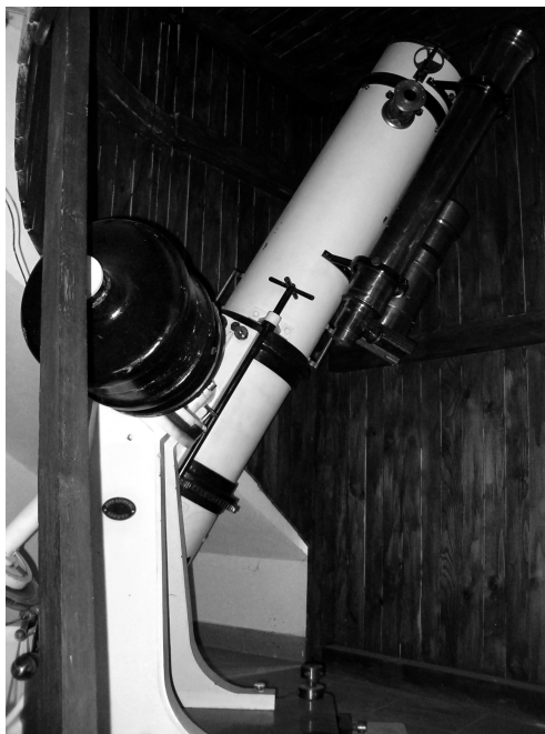
1. ábra. Gothard Jenő 10 hüvelykes Browning-reflektora, amellyel 1881-től csillagászati észleléseit végezte, először vizuálisan, majd 1883-tól szinte teljes egészében fotografikusan.
